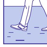
Хождение по поверхности разрешается через 4-6 часов. Укладка и крепление напольного покрытия возможны: через 5-7 суток керамогранит, керамическая и каменная плитка; через 21-28 суток линолеум, ламинат, текстильные ковры, паркет при контроле показателей остаточной влажности основания. Эксплуатация системы теплый пол возможна не ранее 28 суток. Полученное основание не рекомендуется использовать без напольного покрытия.
