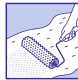
Равномерно залить участки основания, начиная с самой низкой точки, по специальным маякам-реперам до требуемой толщины. Избегать технологических перерывов в процессе работы. Сразу после заливки прокатать слой игольчатым валиком, чтобы удалить пузырьки воздуха для получения более гладкой поверхности.
